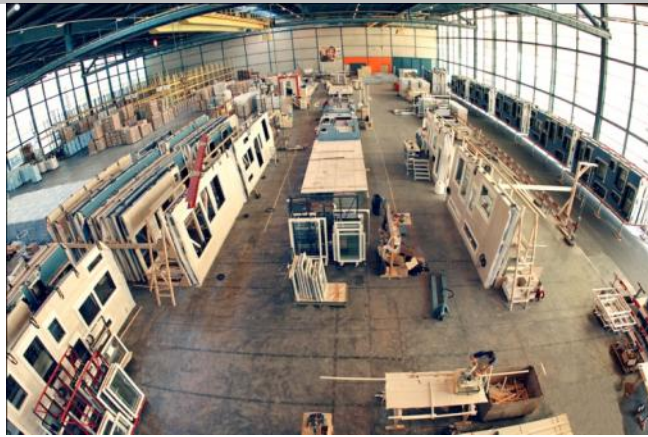
Fertigungshalle ERNE mit Fließbandfertigung SüdPark Fassade
